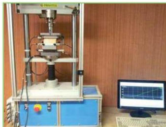
L'écrasement d'éprouvette en laboratoire permet la détermination du module E et de la résistance à la traction indirecte R_{tb} .
